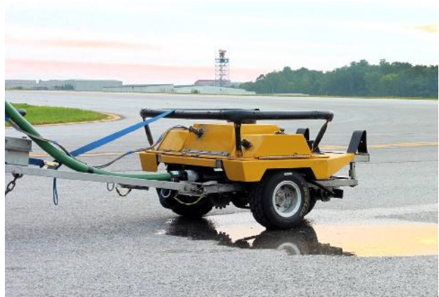
Equipo Grip Tester para medir el coeficiente de rozamiento de una pista.
