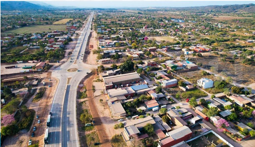
Implementación de técnicas innovadoras y materiales ecológicos se refleja en la iluminación de la carretera, con luminarias tipo LED de 150W distribuidas en 245 postes metálicos cada 30 metros, y 11 postes de hormigón armado conectados con transformadores a lo largo de la
