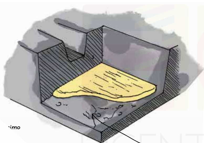
Carpeta de nivelación espesor = 5 cm
